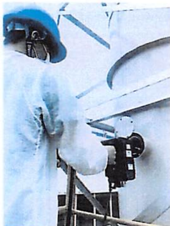
NMP 处理系统废气排放口
