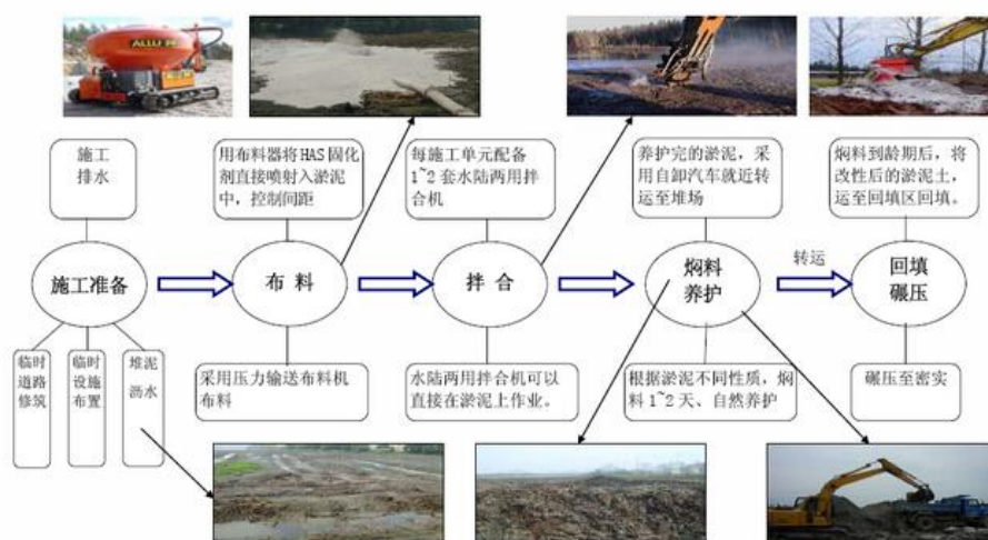
图17 HAS 固化剂淤泥处理技术示意图
