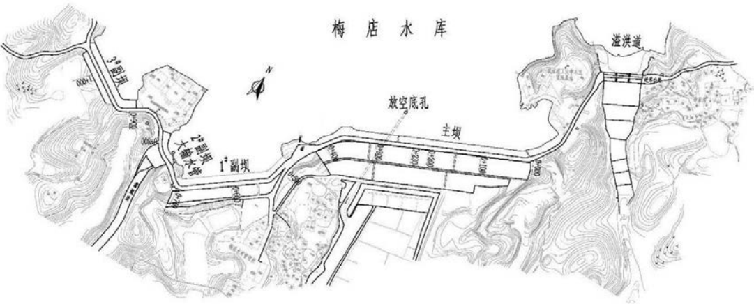
图1 梅店水库主要建筑物布置示意图
